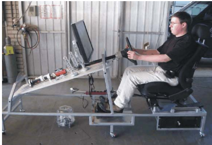
Bild 1: Lenkradaktuator des Steer-by-wire-Prüfstandes
