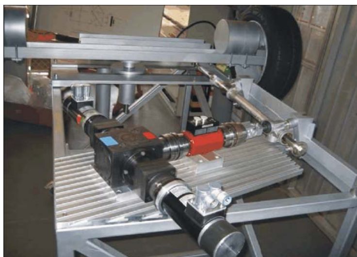
Bild 3: Radstellaktuator des Steer-by-wire-Prüfstandes
