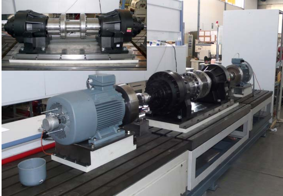
Bild 2: Kleinleistungsprüfstand im IEE, außen sind die Antriebsmaschinen zu sehen in der Mitte zwei Getriebe (Detail links oben), die an ihren langsam drehenden Wellen verbunden sind.
