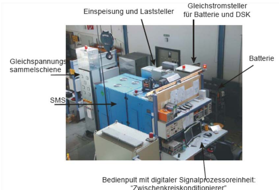
Bild 2: Hardware-Realisierung des in Bild 1 dargestellten Gesamtsystems
