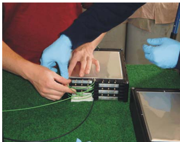
Abbildung 2: Montage der Fasern (grün) zwischen die einzelnen Zellen der Fahrzeugbatterie
