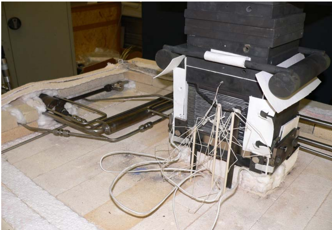
Abbildung 1: Festoxidbrennstoffzelle (wie sie im Teststand verbaut wurde)
