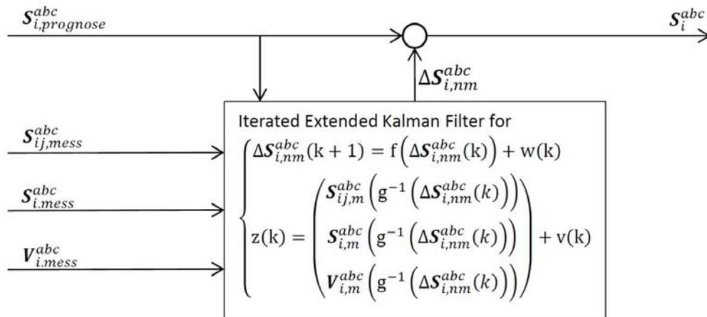
Abbildung: Grundsätzliche Struktur des Knotenlastbeobachters (Nodal Load Observer NLO)
